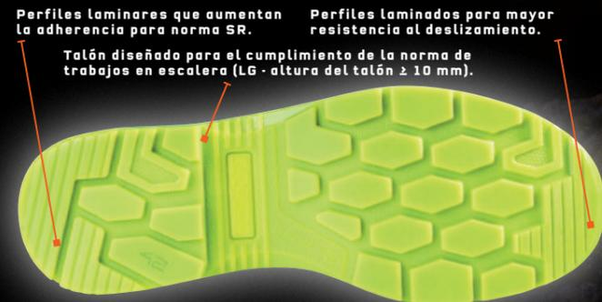
**SUELA INYECTADA DE PU BI-DENSIDAD "FLEXGRIP+" CON DISEÑO ESPECIAL DE LA ZONA DEL TACÓN CONFORME A LOS REQUISITOS PARA TRABAJOS EN ESCALERA CON PELDAÑOS (LADDER GRIP - LG).**
